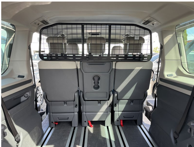
Trenngitter im montierten Zustand.
