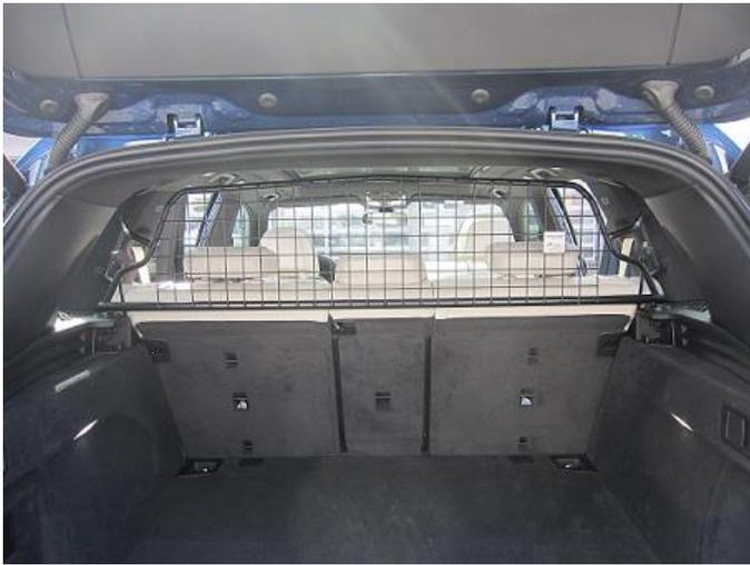
Trenngitter im montierten Zustand.
