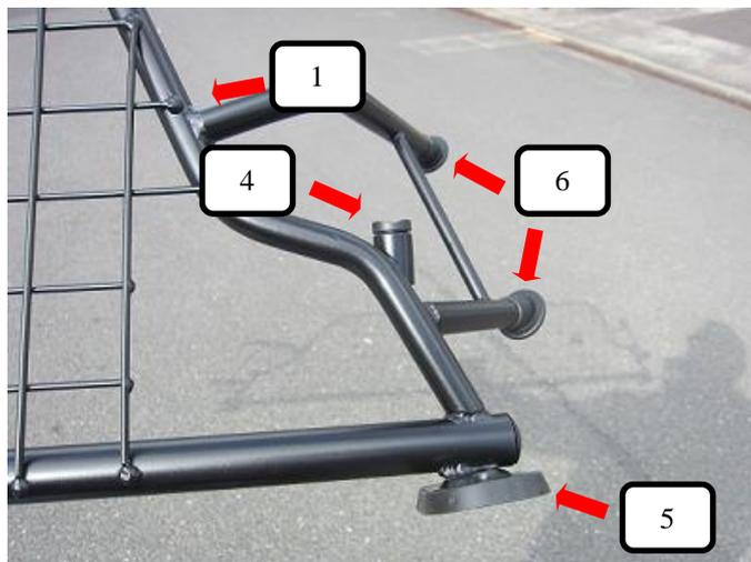
Kunststoffhülse (Pos. 4) in das Trenngitter (Pos. 1), Gummiauflage groß (Pos. 5) und Schutzkappe 25° (Pos. 6) auf das Trenngitter (Pos. 1) stecken.
