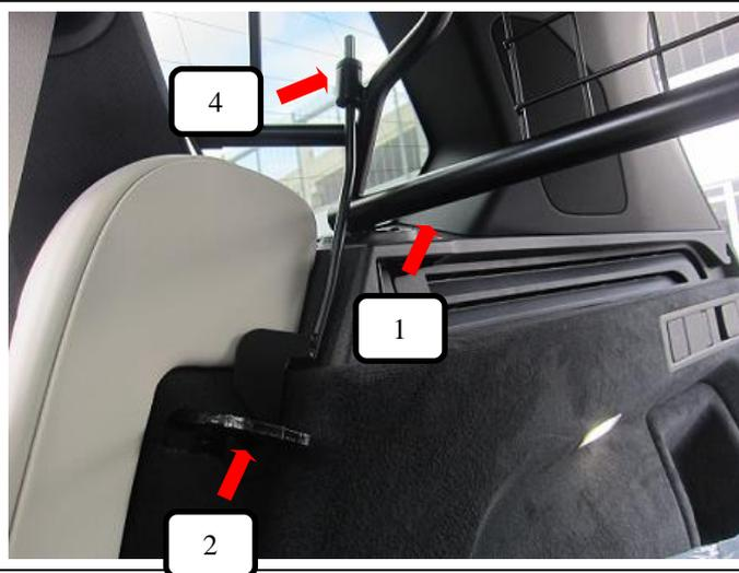
Gewindehaken L+R (Pos. 2) über die Rückenlehnen-Verankerung schieben und nach oben durch das Trenngitter (Pos. 1) sowie Kunststoffhülse (Pos. 4) führen.
