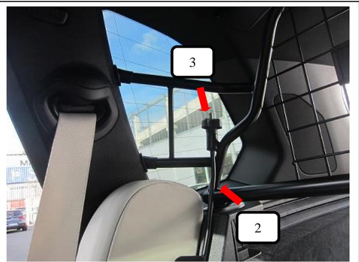
Rändelmutter gewölbt (Pos. 3) auf den Gewindehaken L+R (Pos. 2) aufschrauben und festziehen.
