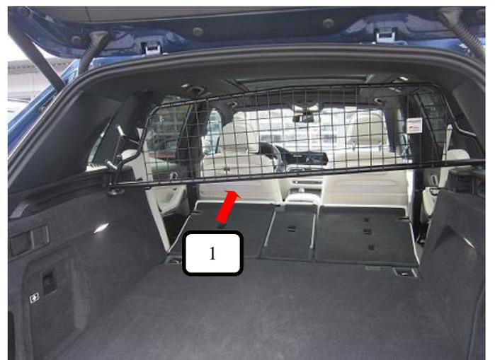
Trenngitter (Pos. 1) wie auf dem Bild in das Fahrzeug einbringen.
