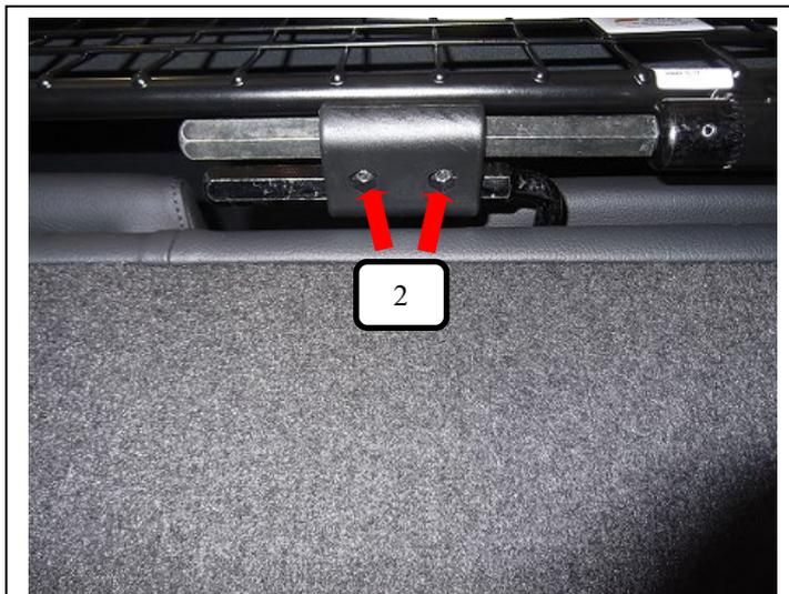
Trenngitter (Pos. 1) mittig ausrichten, jetzt mit dem Inbusschlüssel (Pos. 8) jeweils die zwei Schrauben des Kunststoff-Verbindungselement (Pos. 2) festziehen.
