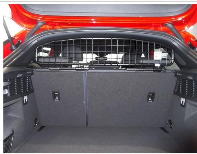
Trenngitter im montierten Zustand.
