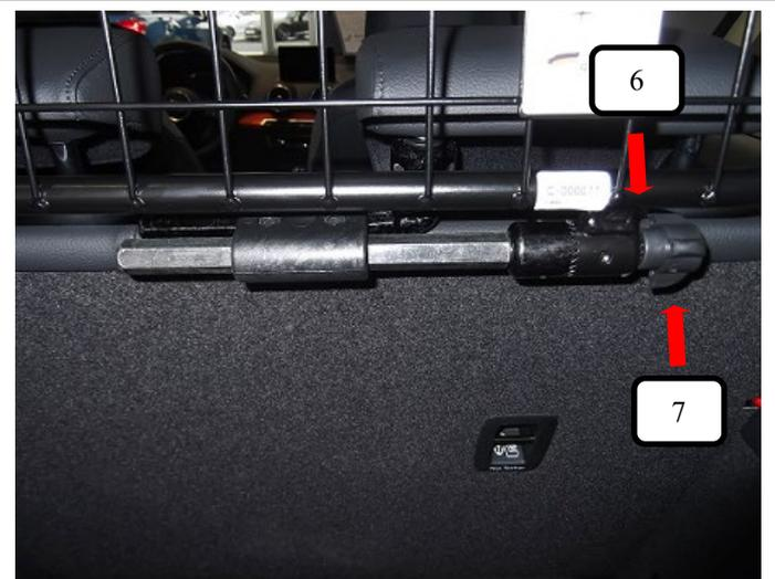
Jetzt mit der Rändelschraube (Pos. 7) und der Zahnscheibe (Pos. 6) festschrauben.
