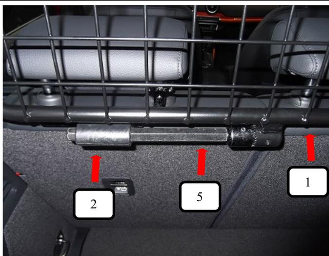
Verbindungsstange mit Verzahnung (Pos. 5) in das Kunststoff-Verbindungselement mit Schrauben (Pos. 2) von rechts nach links schieben, das Trenngitter (Pos. 1) auf die Verbindungsstange mit Verzahnung stecken.
