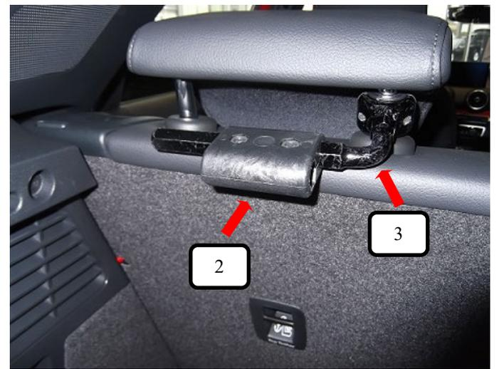
Kunststoff-Verbindungselement mit Schrauben (Pos. 2) mit den Schrauben nach unten auf den Kopfstützenhalter mit Schrauben (Pos. 3) stecken.
