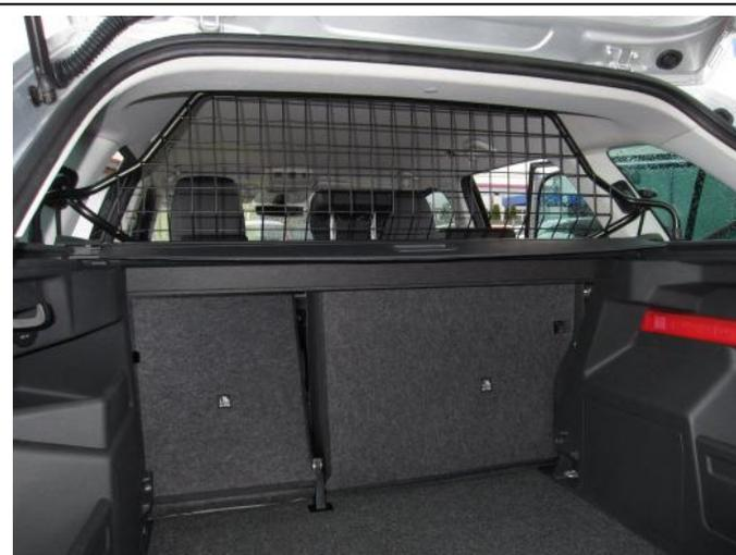
Trenngitter im montierten Zustand.
