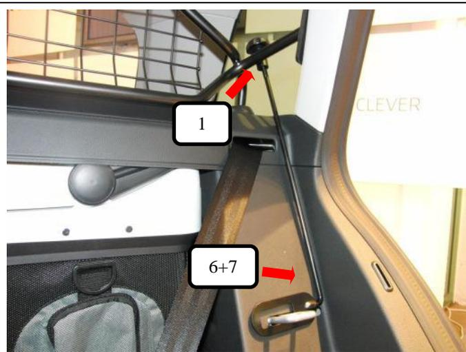
Gewindehaken (Pos. 6 + 7) über die Rückenlehnenverankerung schieben und Gewindehaken (Pos. 6 + 7) durch die Hülzen am Trenngitter (Pos. 1) stecken.
