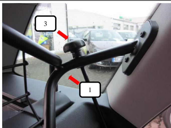
Rändelmutter (Pos. 3) aufschrauben und festziehen. Bitte nur so anziehen, dass das Trenngitter (Pos. 1) spielfrei fixiert ist.
