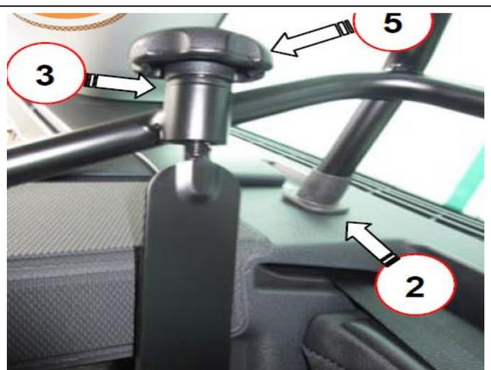
Gewindehaken (Pos. 6 + 7) in die Rückenlehnenverankerung schieben und die Gewindestange durch die Kunststoffhülse an Trenngitter schieben.
